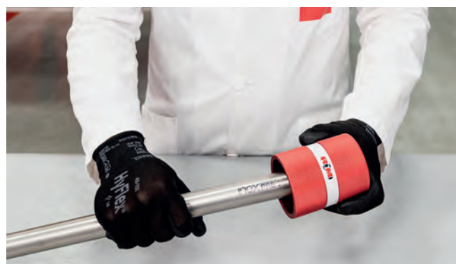
Fig. 27 – Avgradning av röret
