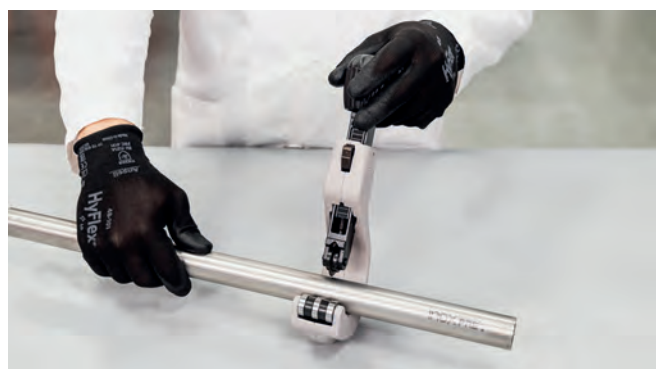
Fig. 26 – Kapning av röret till önskad längd
